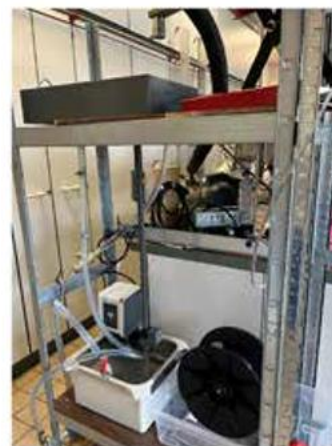
Figura 2: spinning della fibra prodotta in tecnologia TPS
