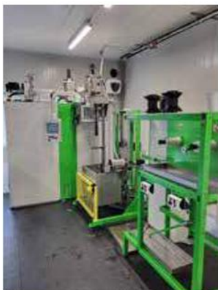
Impianto pilota per produzione fibra in PP e nuova fibra in PMP in sviluppo
